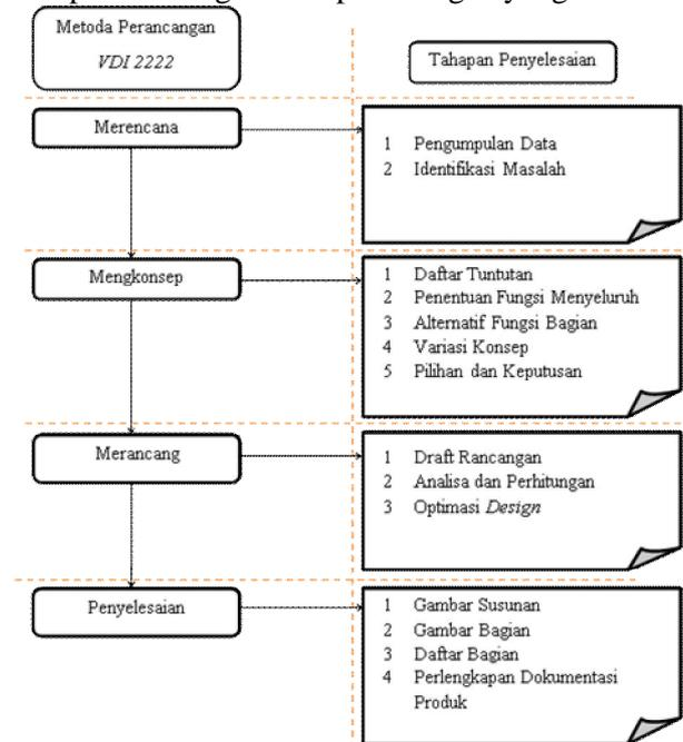
**Gambar 2.1**Diagram Metodologi Perancangan berbasis VDI 2222
